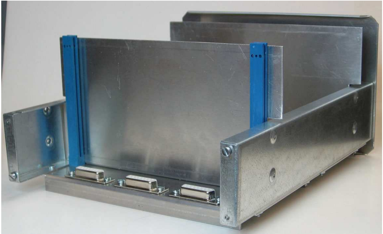
Bild 3 Die Buchsen für die Frontplatte und die Platinenhalter sind bereits eingebaut
