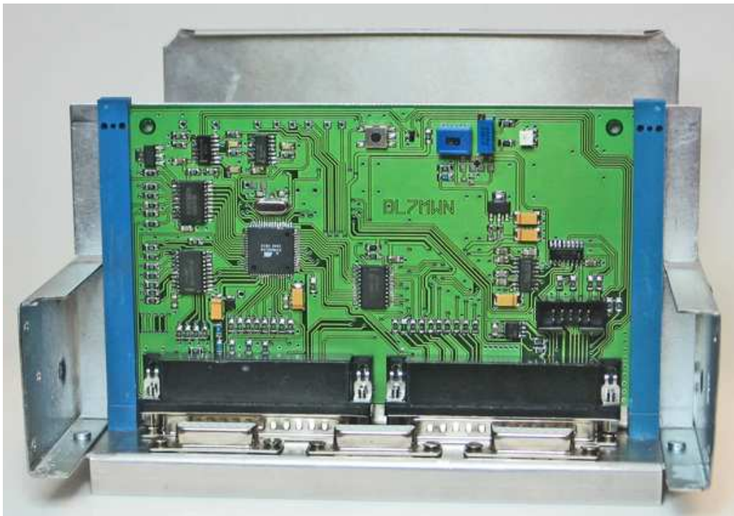
Bild 10 Montageblech 1 mit eingeschobenem, bestücktem Steuerrechner
