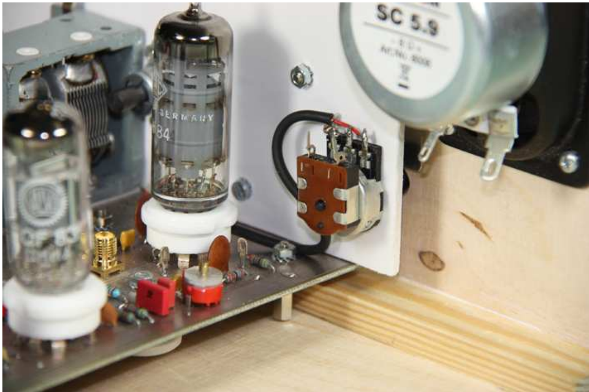
Bild 8 Ein Blick auf das Lautstärke-Poti mit dem Ein/Ausschalter
