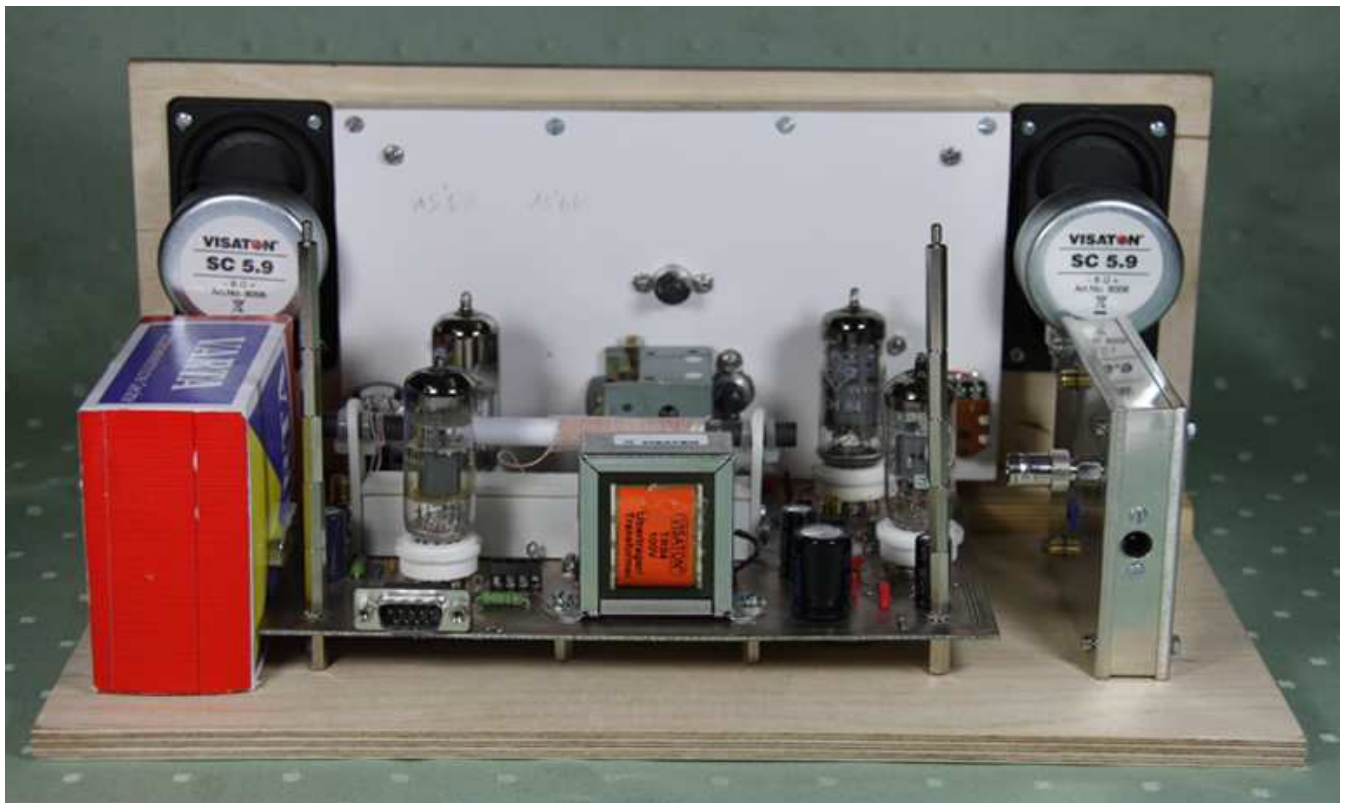
Bild 12 Der Chiccolo im neuen Gehäuse mit Stromversorgung und 49m-Converter
