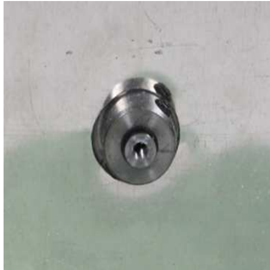
Bild 5 Auf diese Achse ist das Skalenrad aufgeschraubt
