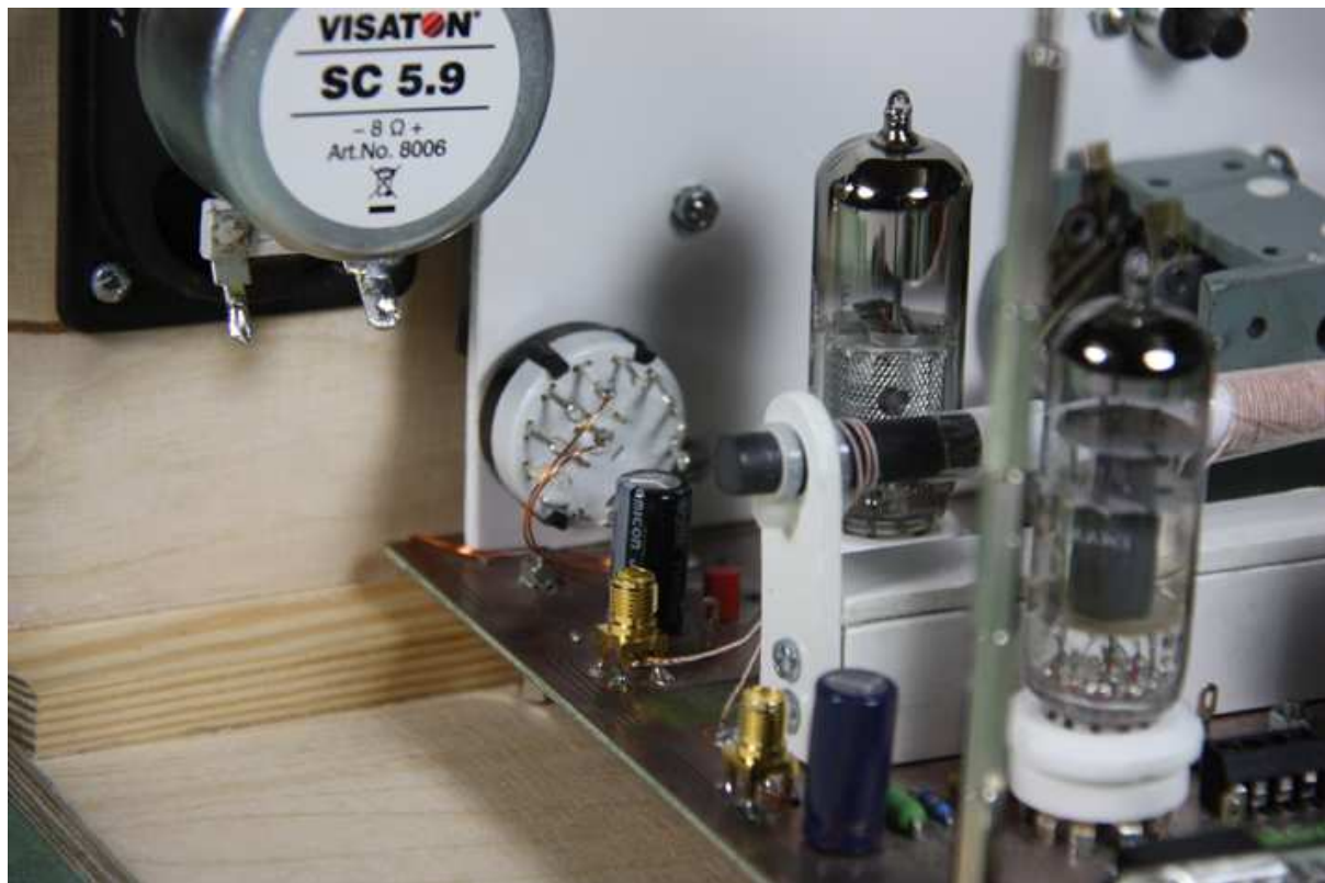
Bild 7 Ein Blick auf den Wellenschalter
