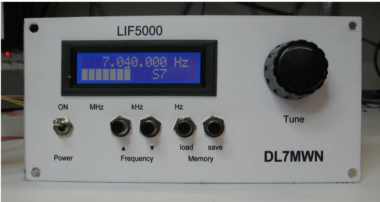
Bild 1 Das analoge und digitale S-Meter
