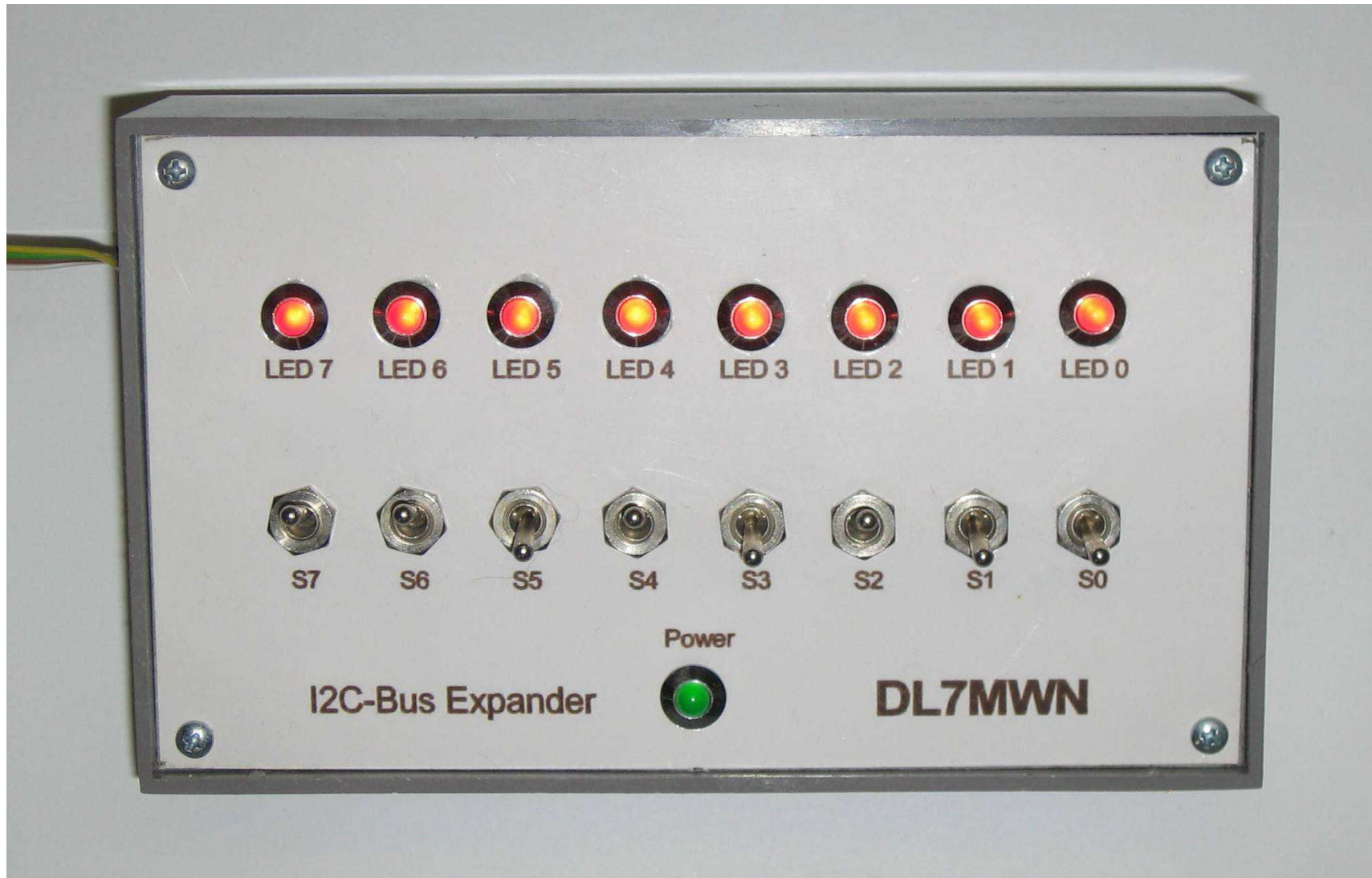
Bild 5 Das ist die Testschaltung für den I2C-Bus
