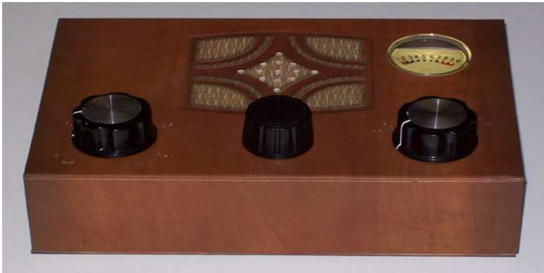
Bild 3 Conrad-Retro-Radio ergänzt mit einem Audion
