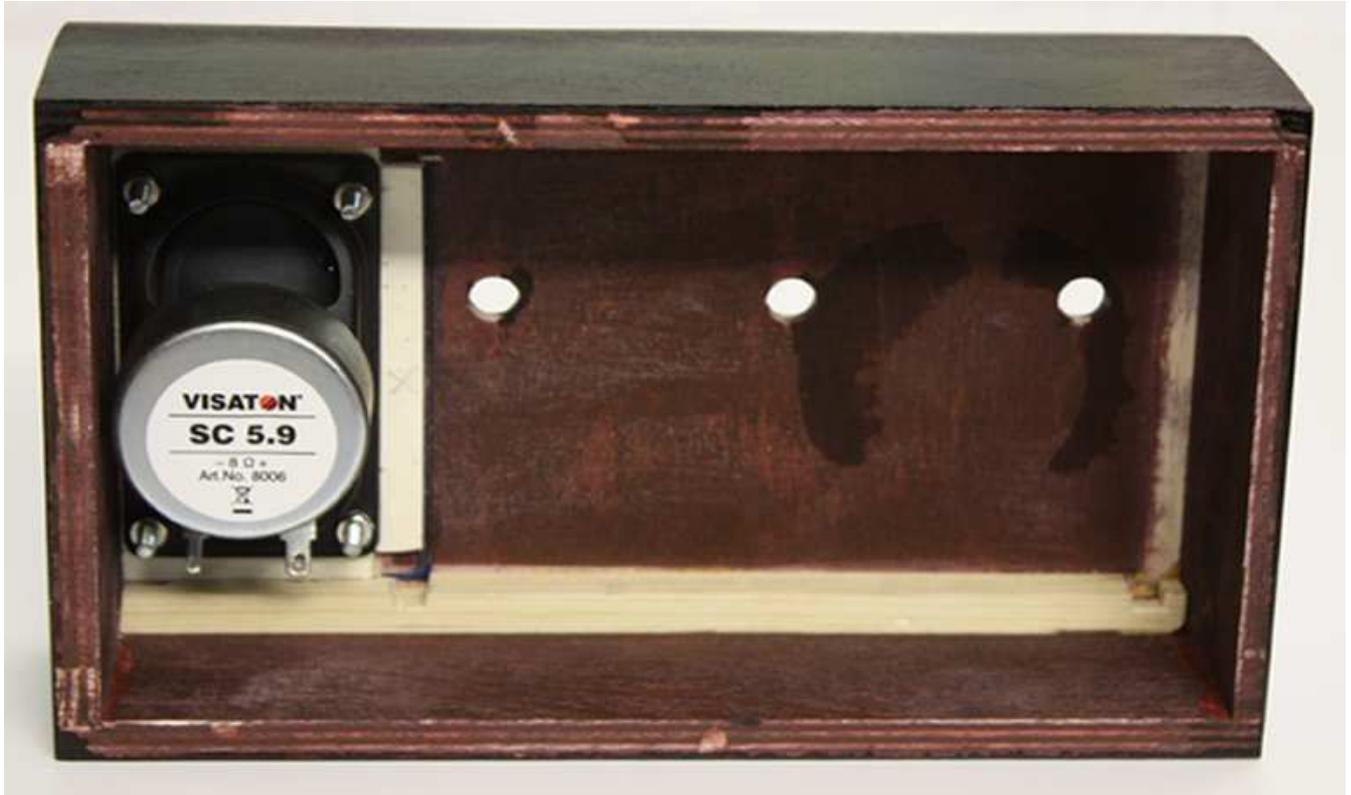
**Bild 4** AM-Retro-Radio --- Gehäuse mit Lautsprecher
